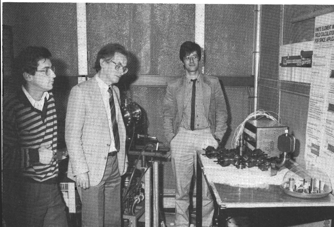
Van der Laan, Wetzer en Danikas rond het 'hart' van de opstelling waarin hoogspanningsvacuümdoorvoeren aan een duurproef worden onderworpen.
